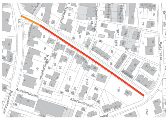
Dieser Mischwasserkanal ist unterdimensioniert und muss gemäss dem vom Kanton bewilligten GEP (Genereller Entwässerungsplan) und nach Überprüfung der hydraulischen Situation auf einer Länge von ca. 220 Metern vergrössert werden (rot). Zudem sind im ersten Abschnitt (orange) auf einer Länge von ca. 40 Metern lokale Sanierungsmassnahmen nötig. Dieser Abschnitt ist in einem schlechten baulichen Zustand (Verkalkungen, Muffenversätze, Wassereintritte).
